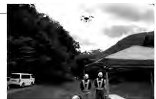
砂防流域でのUAVを用いた砂防堰堤や 流域状況の点検調査
