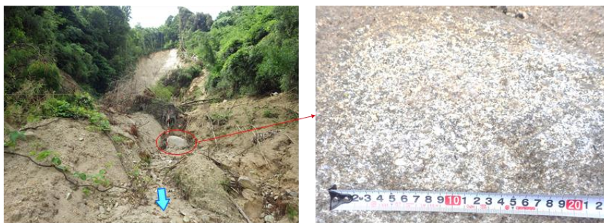
図 5.2.9 土石流の流下区間に出現したコアストーン【ポイント番号⑧】
