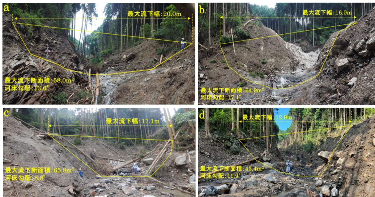
図 3.3.1.4 土石流の流下痕跡計測横断面（いずれも下流から上流に向かって撮影） (2023年7月29日撮影)
