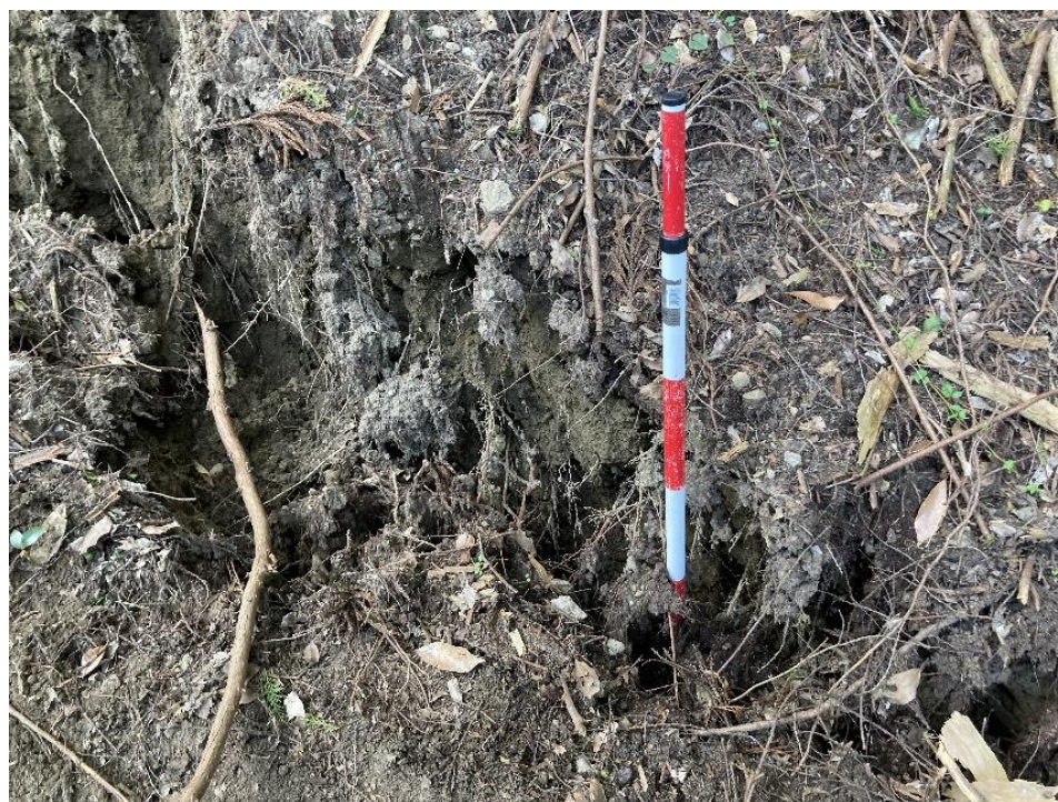
図 3. 2. 2. 5 崩壊地の上部斜面の亀裂 (2023 年 7 月 29 日撮影) 撮影位置は図 3. 2. 2. 1 の f 地点
