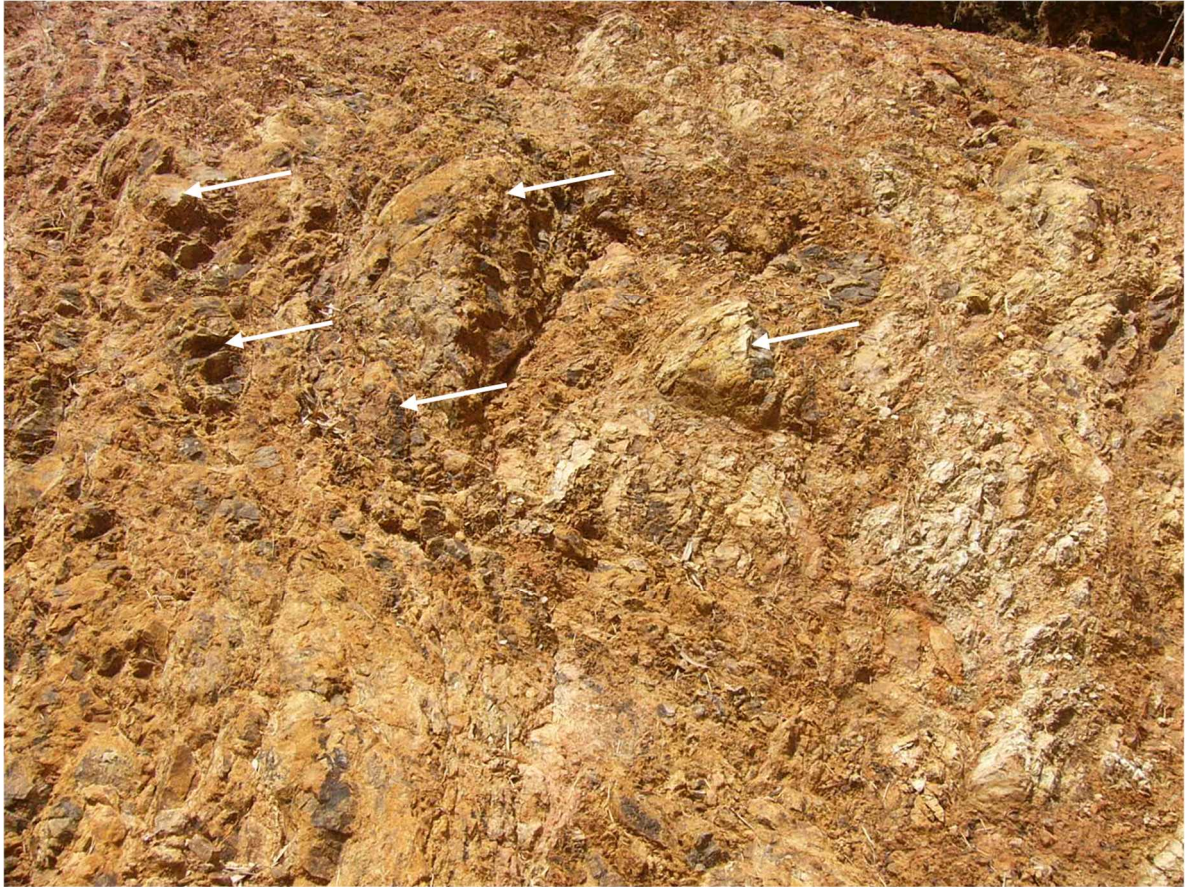
写真 3.3.2 基盤岩 (数十 cm の硬質ブロックを含む強風化粘板岩。矢印は岩塊の代表箇所)
