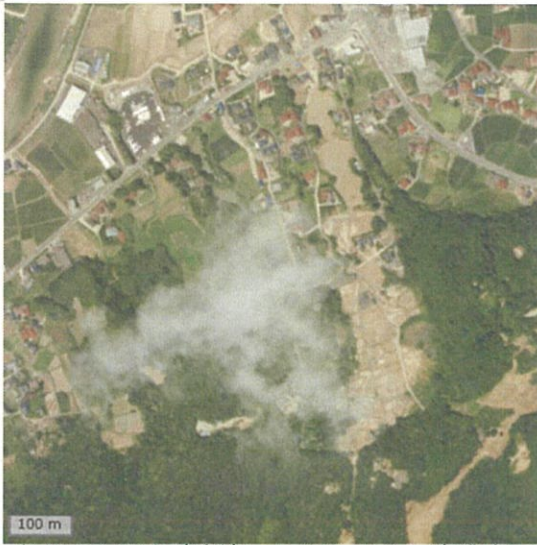
数個のため池が連続しているところに、高濃度に土砂を含む濁流が流れ込んだ状況
