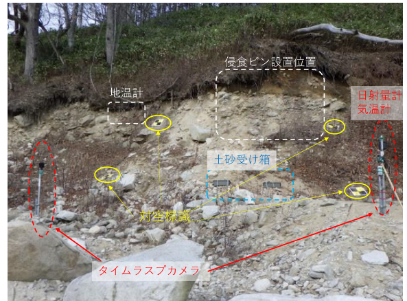
図-1 溪岸裸地斜面における土砂生産の現地観測状況
