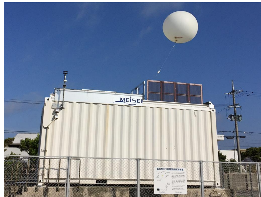
気象庁HPから。上は自動放球機の例。 ガスは水素！
