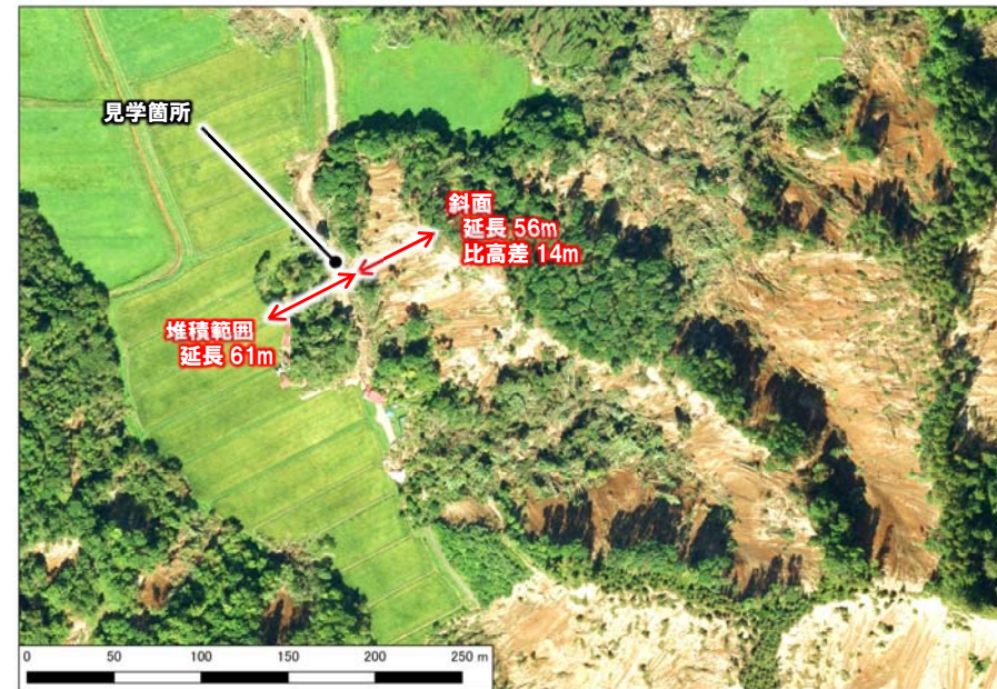
図-6 STOP1 ②緩勾配斜面表層崩壊箇所
