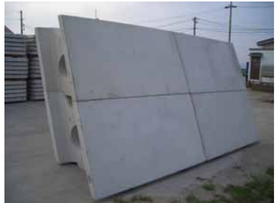
写真-1 自立式大型型枠ブロックの近景
