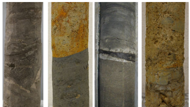
図-2 ボーリング調査で採取されたすべり面の事例
