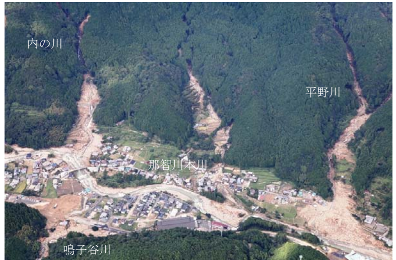
写真-7 土石流の流下・氾濫・堆積区域 (株式会社パスコ/国際航業株式会社 2011年9月5日撮影)
