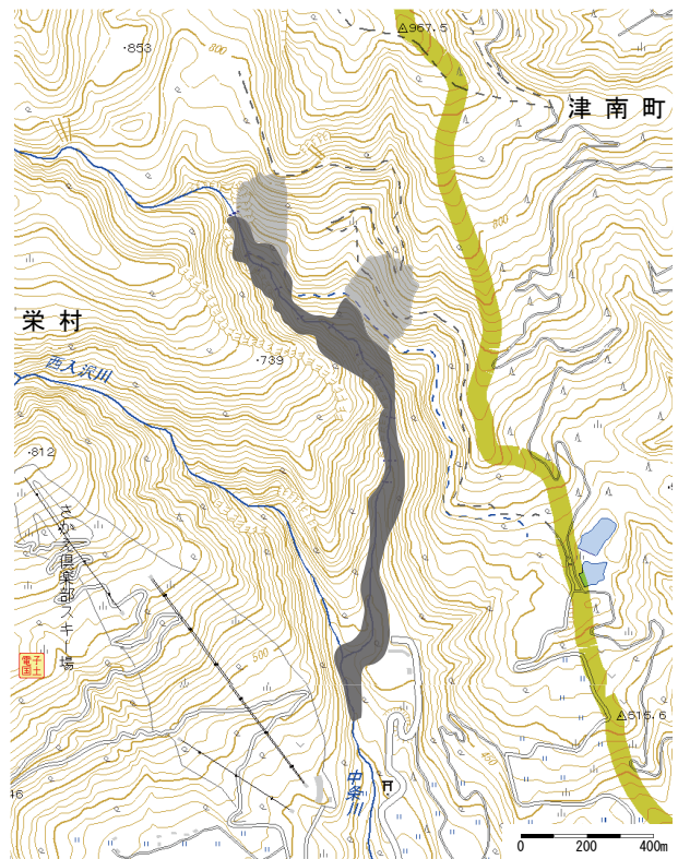
図-2.5.3 地震によって発生した東入沢川沿いの崩壊と堆積域の分布 (電子国土地図に加筆)
