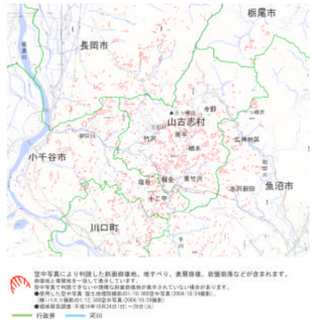
図 - 5 斜面崩壊・地すべりの分布 (国土地理院作成「新潟県中越地震災害状況図」に加筆)
