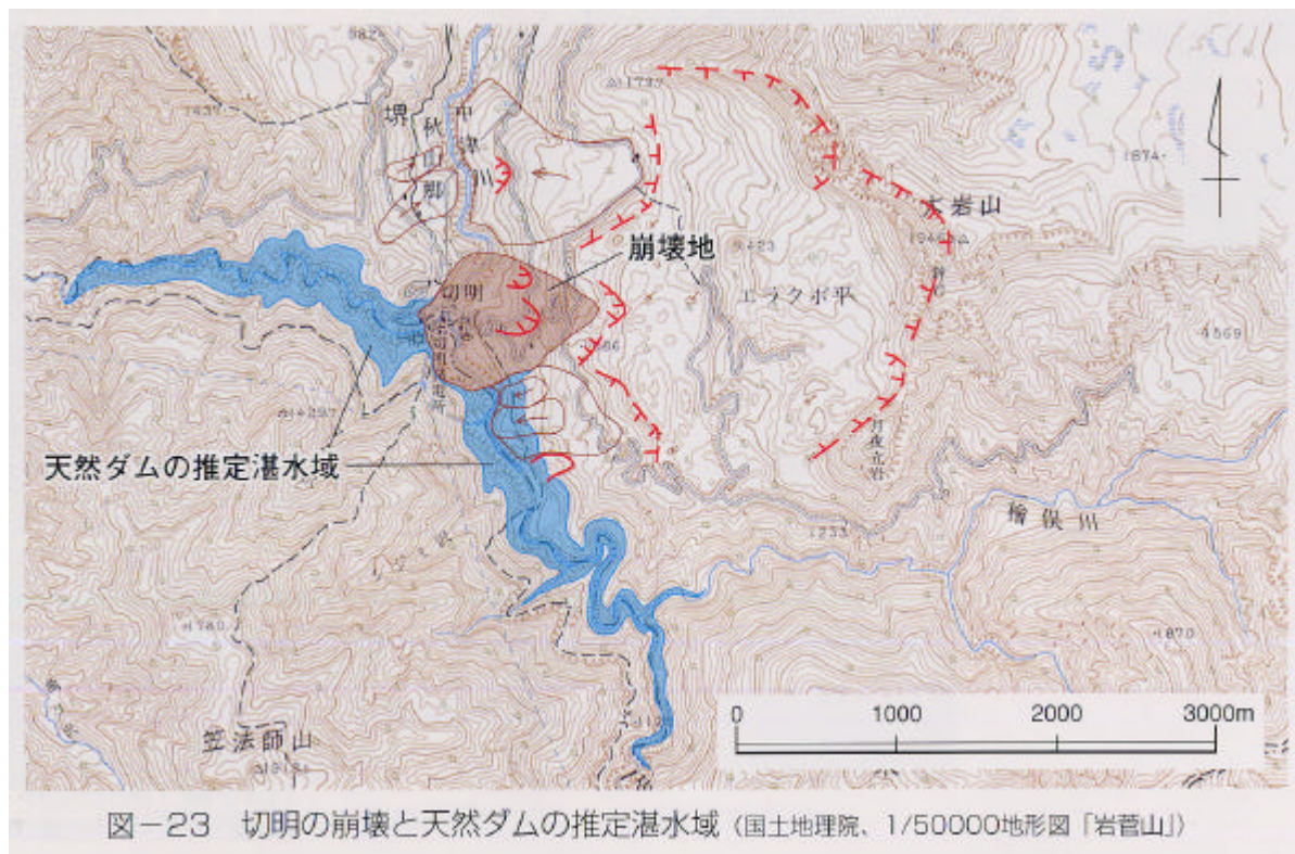
図2 切明の大規模崩壊と天然ダムの推定湛水域（湯沢砂防工事事務所，2001）
