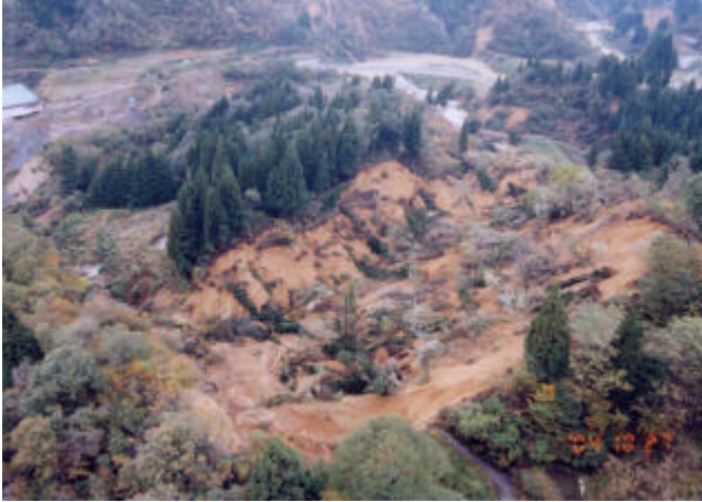
写真 1 東竹沢地すべり主滑落崖 主滑落崖の高さは約25m。すべり土塊は写真右手から左手方向へ約70m移動した。 (2004年10月27日撮影)
