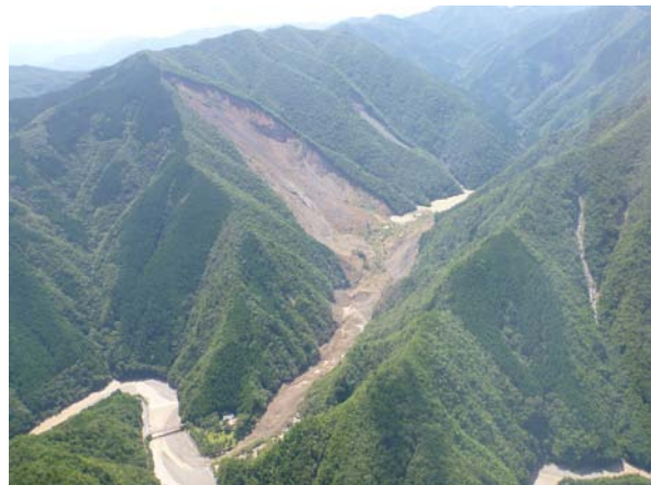
写真-4 奈良県五條市赤谷地区における深層崩壊と天然ダム (2011年9月発生) 土砂量約900万m 3 人的被害なし 提供:(独)土木研究所
