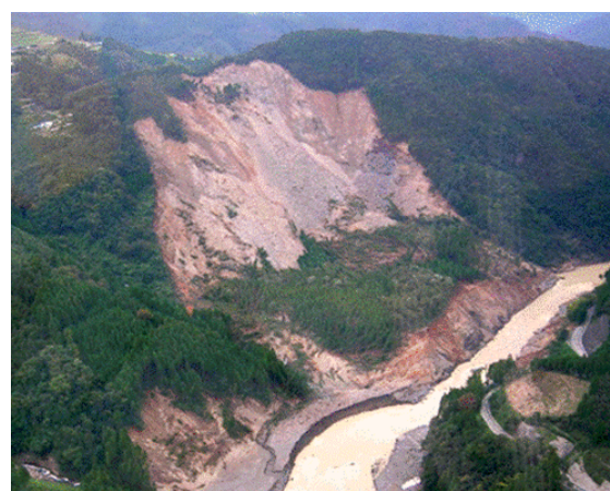
写真-2 宮崎県臼杵郡美郷町野々尾、 耳川における深層崩壊と 天然ダム（2005年9月発生） 土砂量約 1000 万 m^3 人的被害なし 提供：国土交通省
