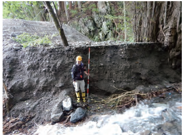
写真-20 上流部(地点d)における土砂の堆積状況 層理の発達する砂礫層の堆積面の勾配は小さい。
