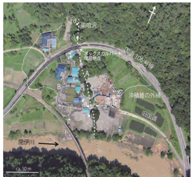
写真-16 巢喰沢からの土砂流出による人家の被災(岩手県河川課提供)
