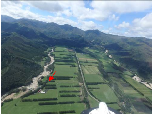
写真 i 小林川の蛇行による側岸侵食・ 屈曲部での氾濫 （写真左側が小林川，右側はペケレベツ川）
