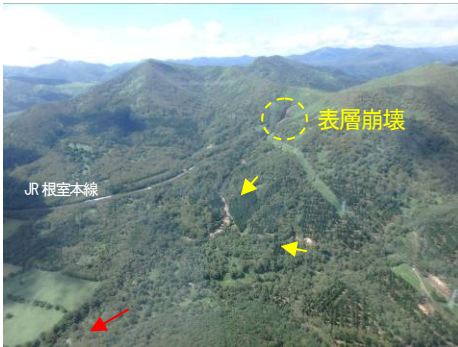
写真 a パンケ新得川本川上流の表層崩壊と 写真 b 九号川とパンケ新得川の合流点 土石流
